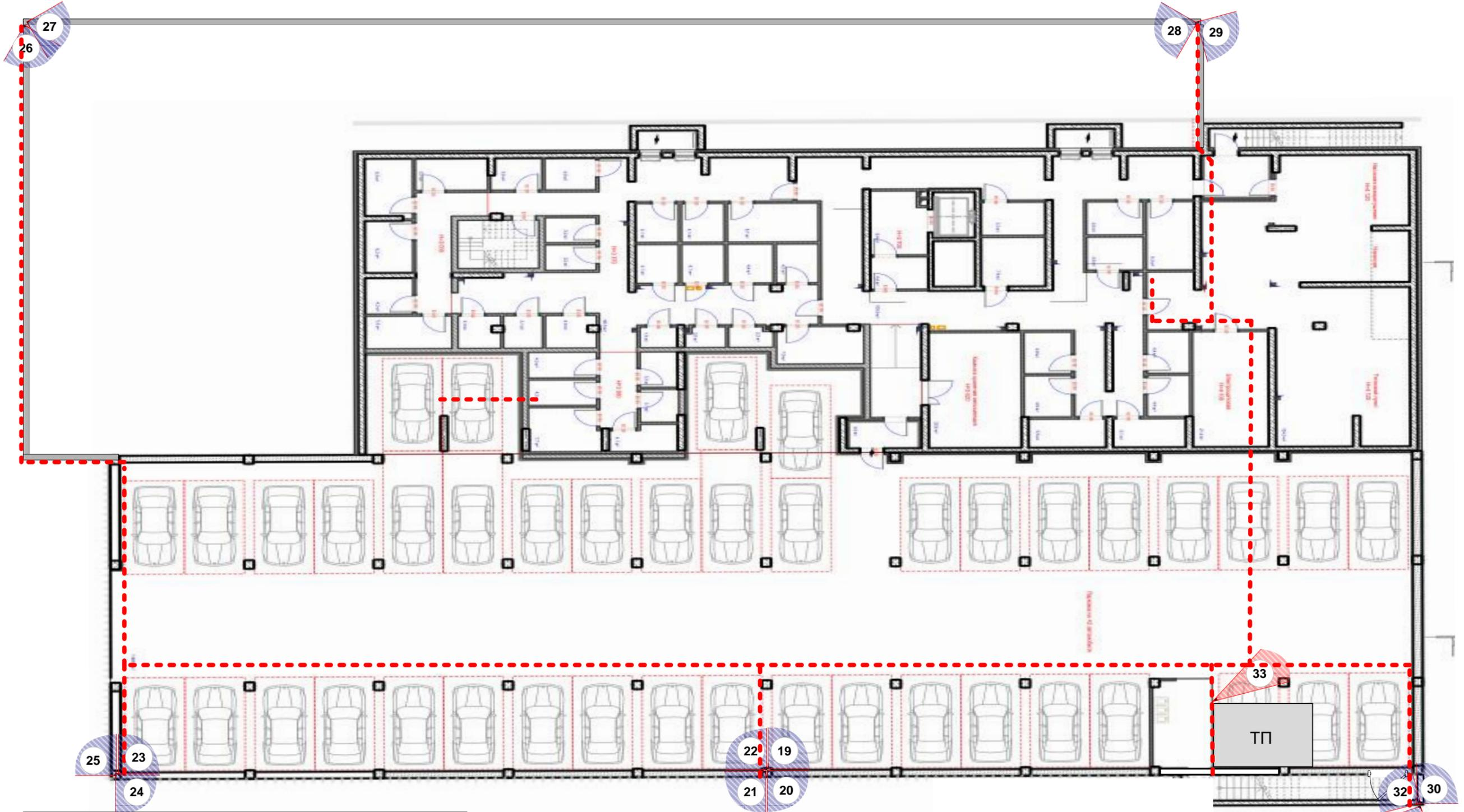
**Внимание: Камеры размещаются на опорах ограждения. В связи с этим опоры для установки камер необходимо удлинить до H=3м. Диаметр опоры не менее 100мм.**
