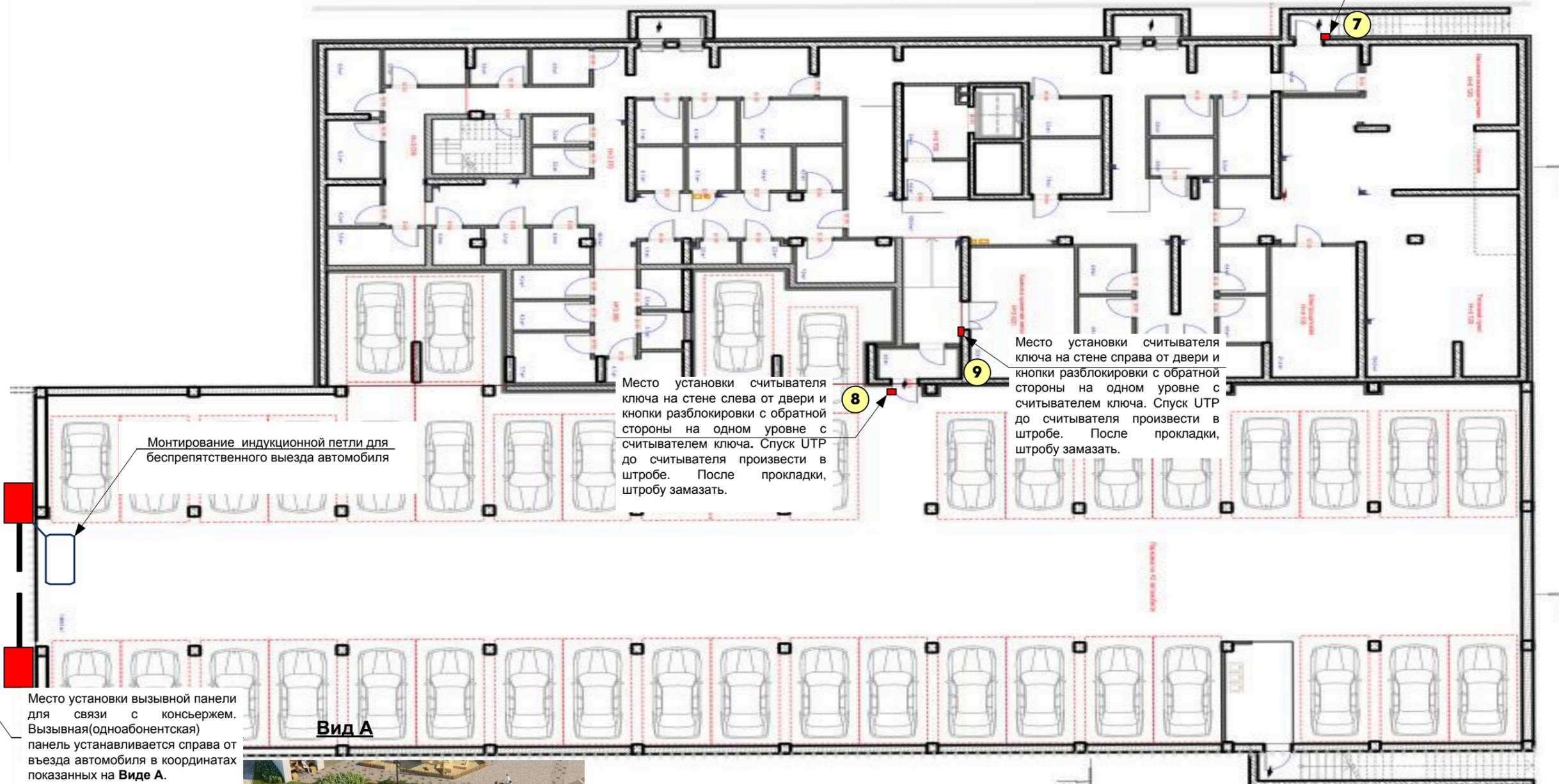
Монтаж индукционной петли для беспрепятственного выезда автомобиля
